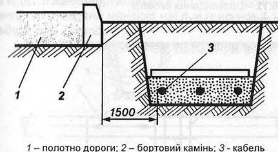
Рисунок 6.11 – Прокладання кабелів паралельно автомобільним дорогам
